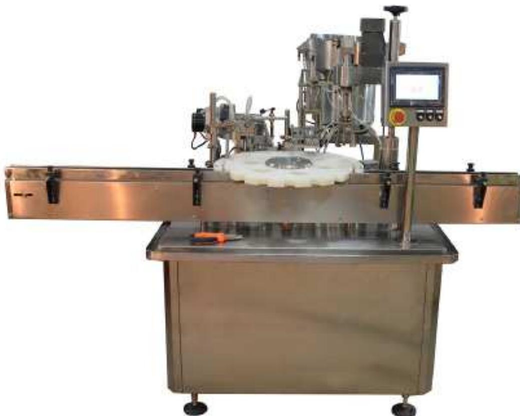
Моноблок разливочно-укупорочный «Мастер» для флаконов с пульверизатором МЗ-400ЕД позволяет в автоматическом режиме реализовывать ключевые технологические процессы упаковки продукта. Высокая производительность наряду с компактностью и простотой обслуживания обеспечивает оптимальность внедрения данной модели в производства различного уровня.
