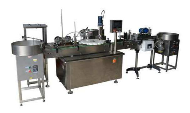
Комплексная линия «Мастер» для розлива масел — комплект оборудования, реализующий в технологической последовательности операции по подаче флаконов, розливу, ориентации пробок/колпачков, укупорке тары, а также этикетировке и маркировке готовой продукции. Машина создана с применением инновационных технологий и в соответствии с европейскими стандартами качества.
