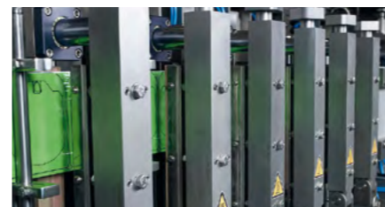
Parallel motion vertical sealing bars. Zona soldaduras verticales con sistema de movimiento en paralelo.
