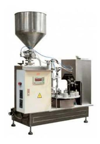
Моноблок фасовочно-укупорочный в настольном исполнении МЗ-400ЕД обеспечивает точность дозирования лекарственных препаратов и герметичность укупорки флаконов различного формата. Модель отличается от других аналогичных по функционалу моноблоков, представленных в нашем каталоге, настольным исполнением, что делает ее оптимальной для оснащения небольших и средних фармацевтических и ветеринарных производств.
