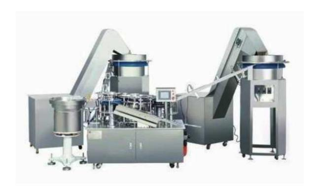
Автоматическая линия фасовки в шприцы "Мастер" — это универсальный высокопроизводительный комплекс, реализующий процесс наполнения шприцев лекарственными препаратами. Дозирующая система представляет собой комплект роторно-поршневых насосов-дозаторов, которые управляются двумя независимыми серводвигателями. Оптимальная синхронизация работы всех узлов позволяет достигать высокой точности розлива без риска загрязнения продукта.
