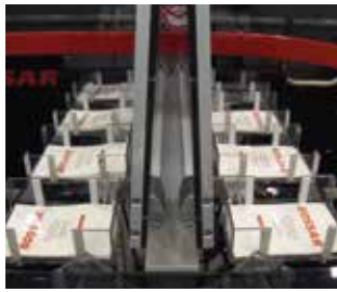
Pouch feeder magazine. Almacén suministrador de bolsas.
