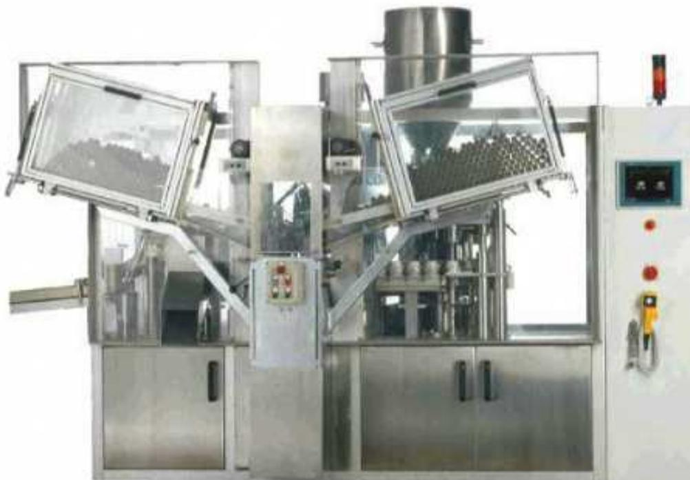
Автоматический моноблок (9000 в час) фасовки пластиковых туб «Мастер» МЗ-400ЕД — одна из самых мощных тубонаполнительных машин, представленных в нашем каталоге. Оборудование полностью обеспечивает потребность средних и крупных производств в создании качественной упаковки своего товара.
